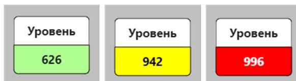
Рисунок 31 – Объект Датчик (с разными значениями тега)
