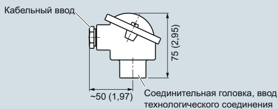
Соединительная головка, алюминий, тип BA0, размеры в мм (дюймах)
