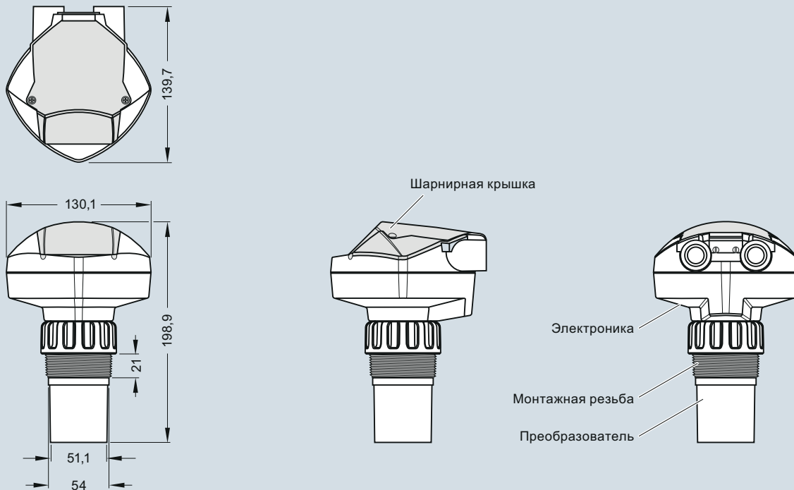
SITRANS Probe LU, размеры в мм
