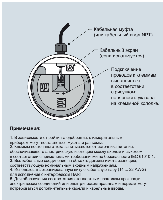
SITRANS LR560, схема соединений
