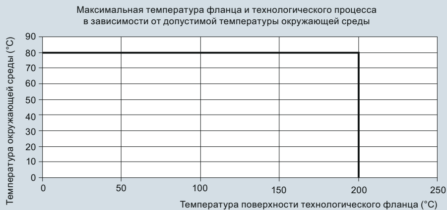
SITRANS LR260, температурная кривая для окружающей среды/поверхности фланца
