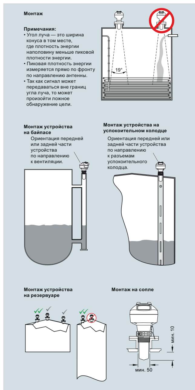
Монтаж SITRANS LR250 с антенной из PVDF, размеры в мм
